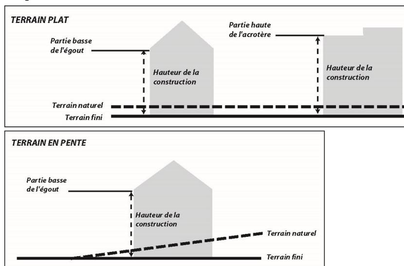
La hauteur maximale des constructions est limitée à 9 mètres. Elle est portée à 10,5 mètres à l'acrotère principal pour les toitures terrasses.
