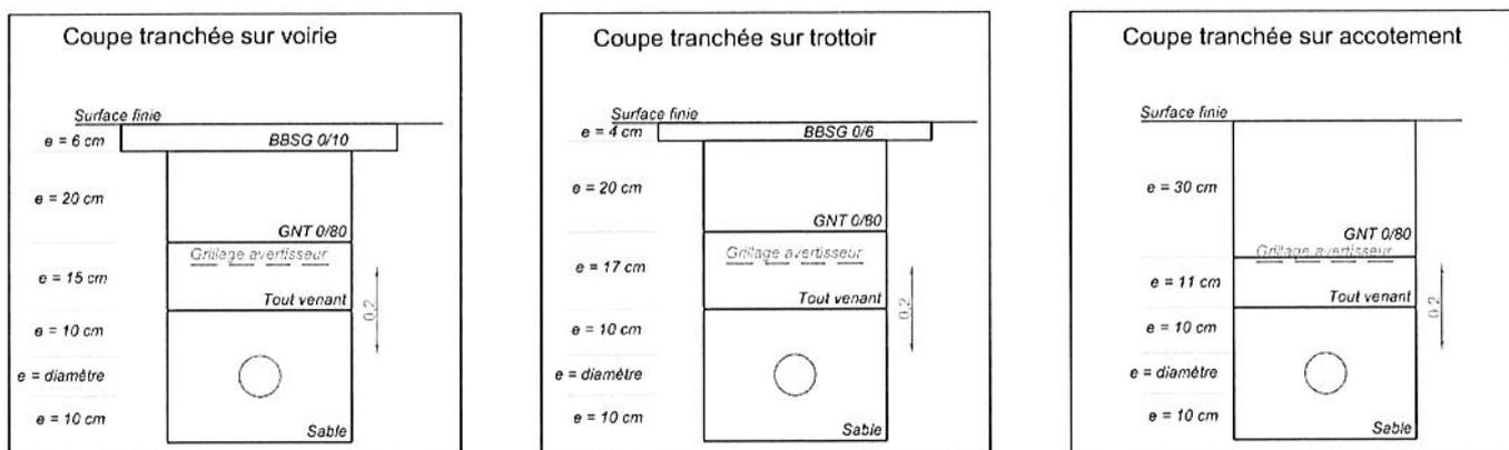
Exemple pour un fourreau/canalisation Dn90 à -60 cm
