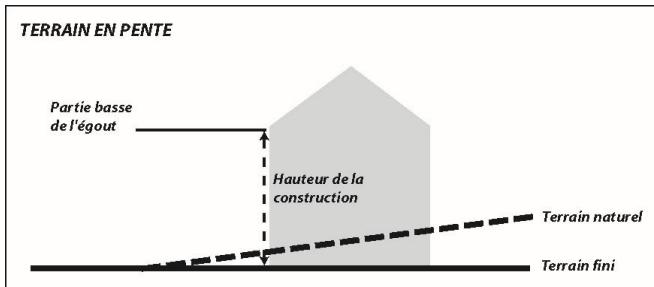
Pour les équipements à usage d'intérêt collectif, la hauteur maximale des constructions est limitée à 9 mètres à l'égout de toiture, cette hauteur est portée à 10,5 mètres à l'acrotère principal pour les toitures terrasses.
