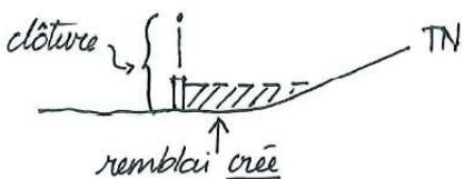
En zone inondable, les clôtures dont la perméabilité est insuffisante pour assurer l'écoulement des crues et des ruissellements sont interdites. L'implantation de haies, constituées d'essences variées, éventuellement doublées d'un grillage à maille souple, est préconisée.
