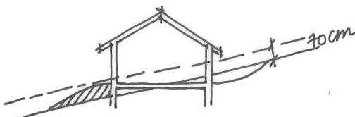
Les remblais doivent être limités aux abords de la construction et non répartis sur l'ensemble du terrain.
